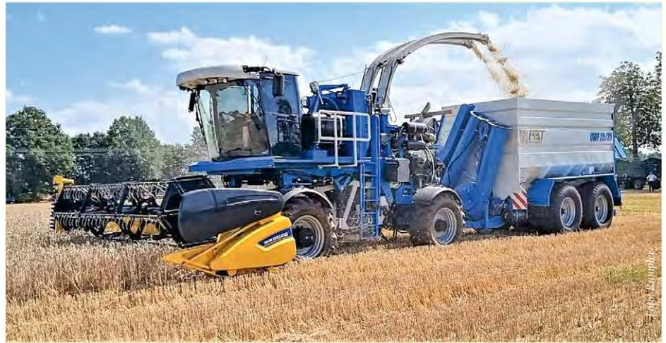
**Abb. 2:** Technologieträger Kompakternte mit neuartigem Feldüberladewagen.
