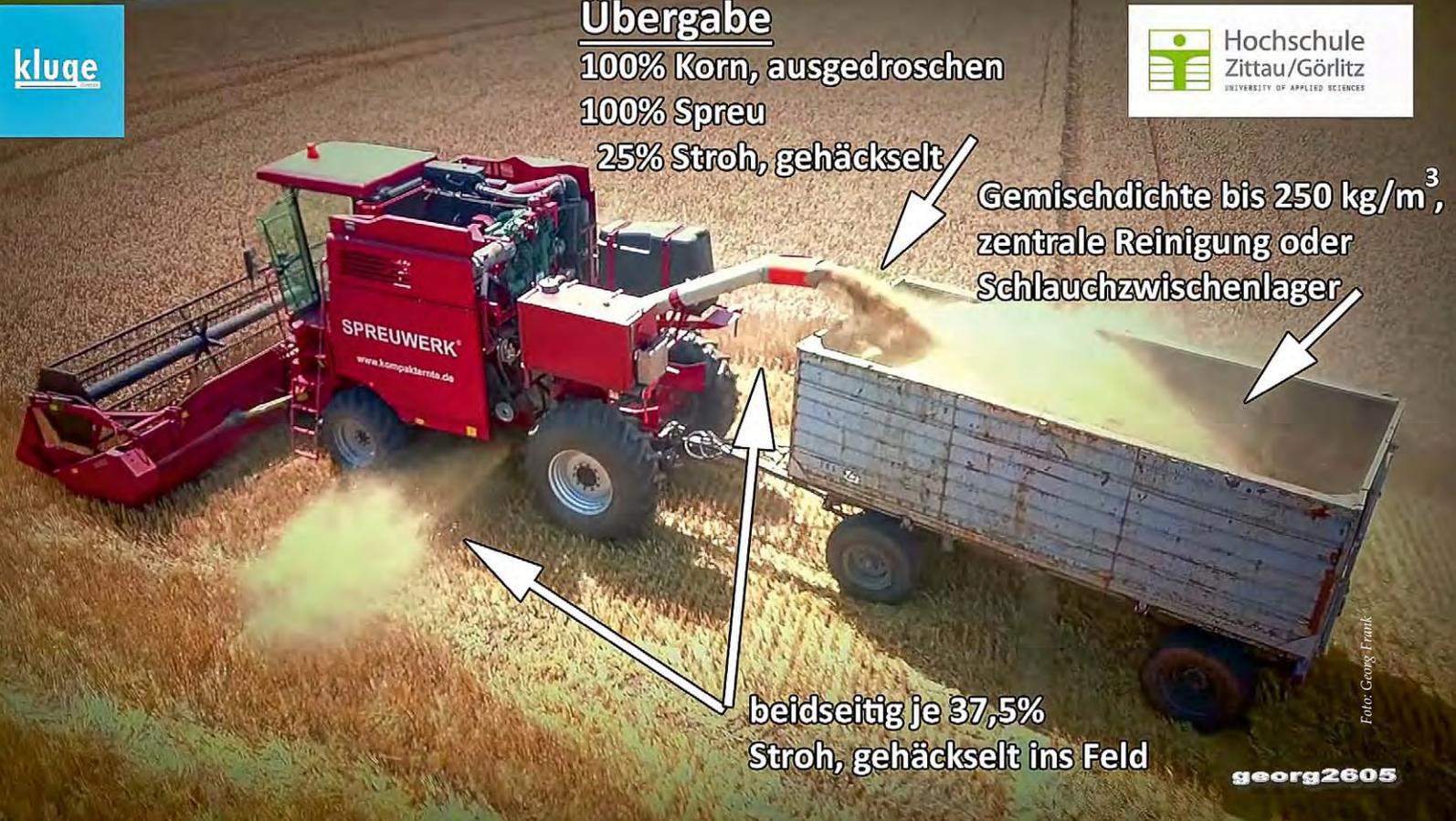
Abb. 1: Kompakternter mit Verfahrensdaten und erkennbaren Ökozielen.
