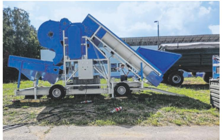
**Semimobile Reinigungsanlage:** Langstrohanteile werden separiert, eine Feinreinigung ist nachgeschaltet. FOTO: JÖRG MÖBIUS
