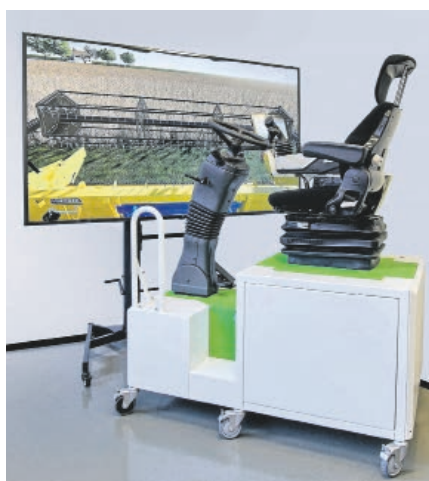
Bildschirmfoto Kompakternte mit dem Landmaschinen-Simulator. Der Bedienstand (r.) entspricht dabei genau dem Original.
