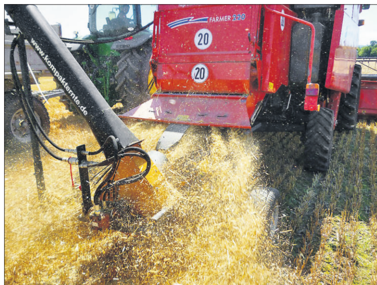
Mit einer mobilen Vorrichtung wird in verschiedenen Kulturen Spreu und Stroh mitgeerntet, um an Testmaterial zu kommen. FOTOS: JOHANN RUMPLER
