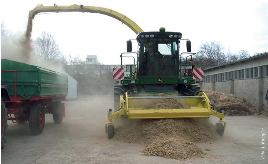
Abb. 4: Der Cracker-Einsatz bringt 16 % mehr Methanausbeute.
