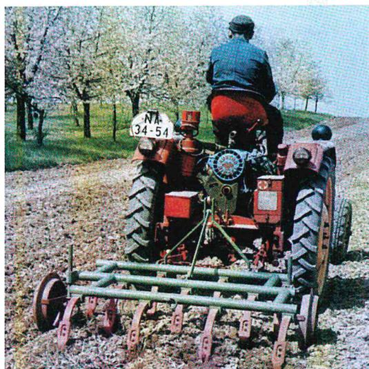
Der RS 09 mit einem Grubber im Jahr 1967. Das „Austro Diesel“ am Kühlgebläse des Zweizylinder-V-Motors deutet auf den Lizenzgeber Warchalowski (Wien) hin.
