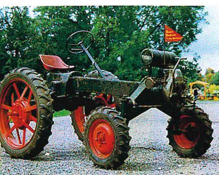
Einer der wenigen erhaltenen IFA-Maulwürfe. Der Einzylinder-Zweitakt-Benzinmotor leistet 8,75 PS. Die Kupplung ist vorne, das Getriebe hinten.
