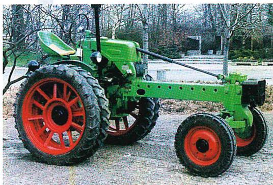
Die Stall-Variante RS 09/160. Die Achsvorgelege sind nach oben geschwenkt, der Rahmen ist kürzer, damit der Schlepper niedrig und kompakt ist.
