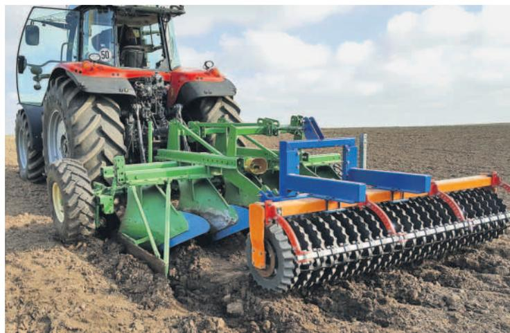
**Dank Zapfwelldurchtrieb** kann statt der Walze auch eine Drillkombination hinter dem Pflug laufen.
