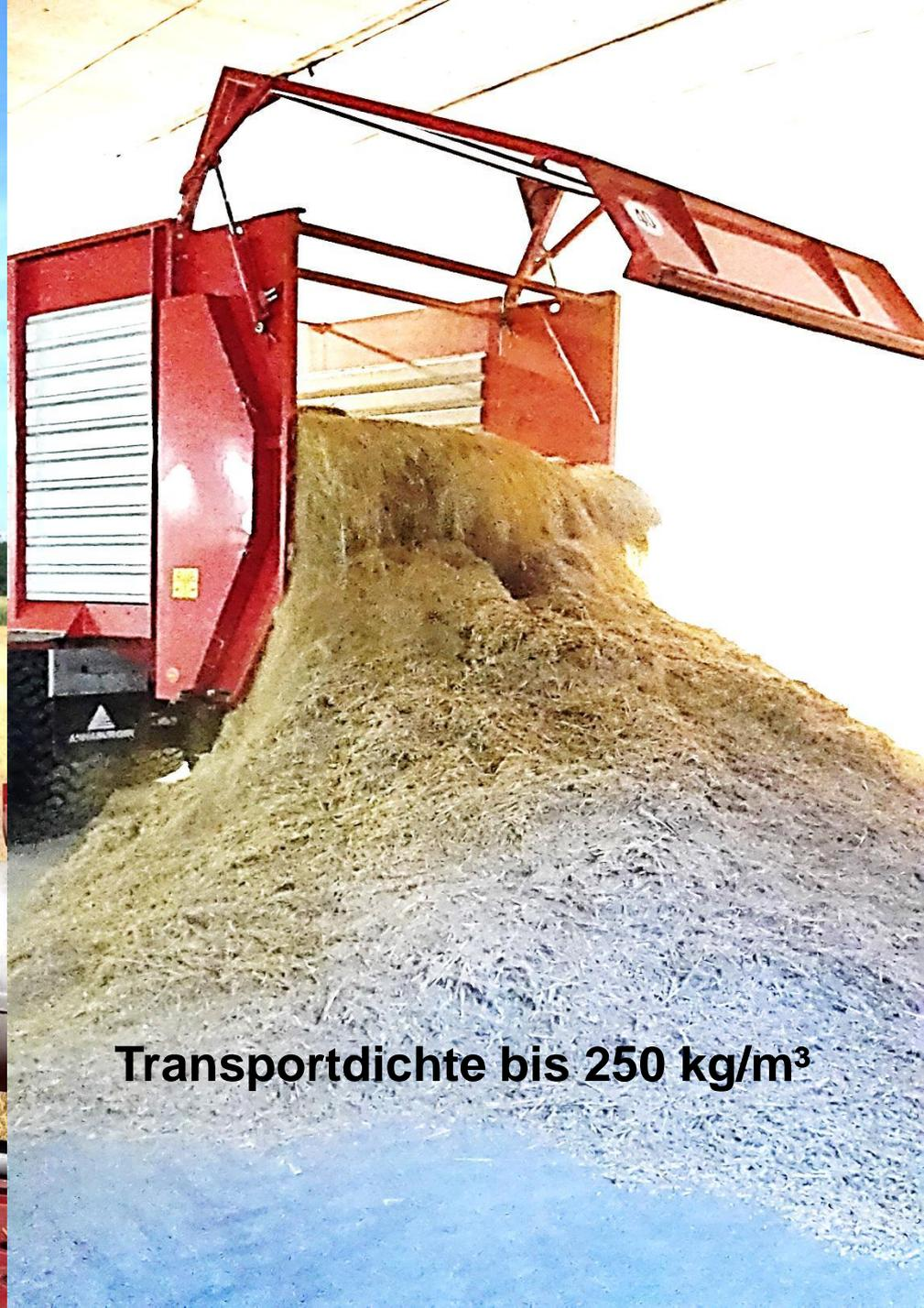
Transportdichte bis  $250 \text{ kg/m}^3$
