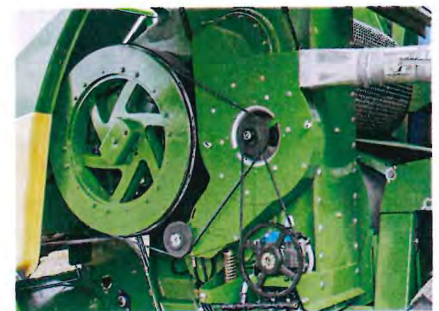
Hinter Schwungrad und Gebläse sitzt ein riesiges Getriebe zum Antrieb der Matrizenwalzen.
