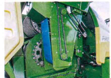
Der Blick von der rechten Seite unter die Haube auf den Pellet-Elevator.
