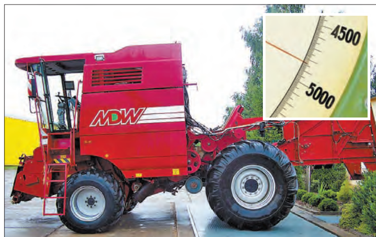
Verwandlung eines Mähdreschers. Der gute alte „Arcus“ hat erheblich Federn lassen müssen, um Platz für den Großbunker zu schaffen. Die Reinigung wurde komplett ausgebaut, geblieben ist nur das Rotor-Dreschsystem. Ergebnis: 5 t weniger Gewicht und mehr Gestaltungsraum! FOTOS: SYBILLE RICHTER
