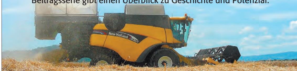
Mähdrescher mit Aufsatzbunker im Einsatz.
