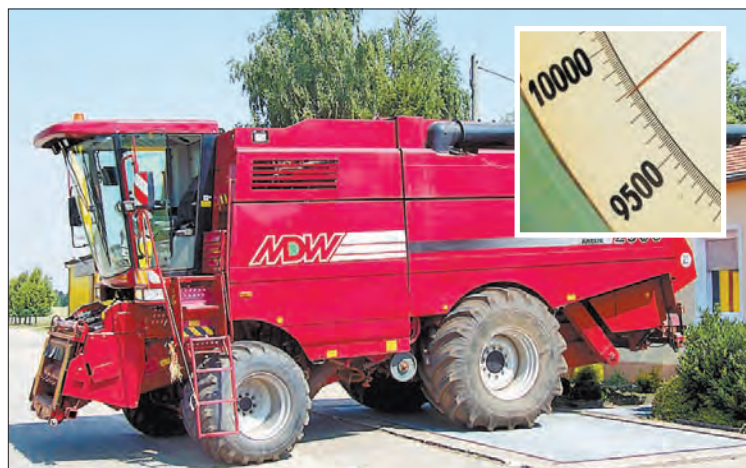
Verwandlung eines Mähdreschers. Der gute alte „Arcus“ hat erheblich Federn lassen müssen, um Platz für den Großbunker zu schaffen. Die Reinigung wurde komplett ausgebaut, geblieben ist nur das Rotor-Dreschsystem. Ergebnis: 5 t weniger Gewicht und mehr Gestaltungsraum! FOTOS: SYBILLE RICHTER
