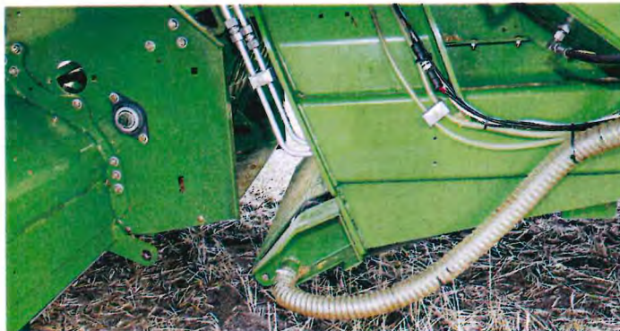
Dieser Spalt hinter dem Förderrotor soll zusammen mit der Neigung des nachfolgenden Förderbands dafür sorgen, dass Fremdkörper abgeschieden werden.
