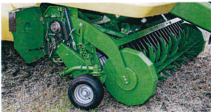
Der 140 kg schwere Zinkenpacker sorgt dafür, dass die Pickup das Material dosiert aus dem Schwad aufnehmen kann.
