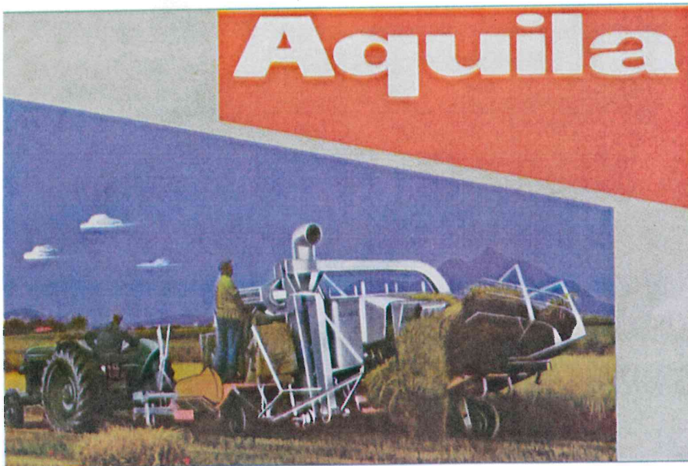
Abb. 110: Der Aquila mit Reinigung und nachlaufender Strohpresse. Der Antrieb erfolgte hier über die Schlepperzapfwelle. (Epple um 1955/Archiv Kühnstätter)
