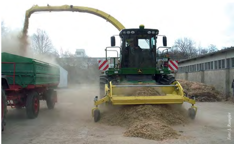
Abb. 4: Der Cracker-Einsatz bringt 16 % mehr Methanausbeute.
