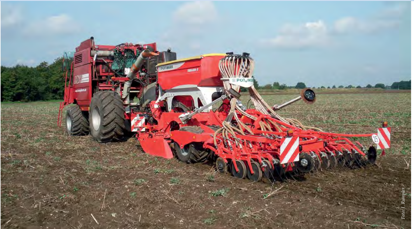
Abb. 2: Demonstration einer Kopplungslösung mit einer Sämaschine.
