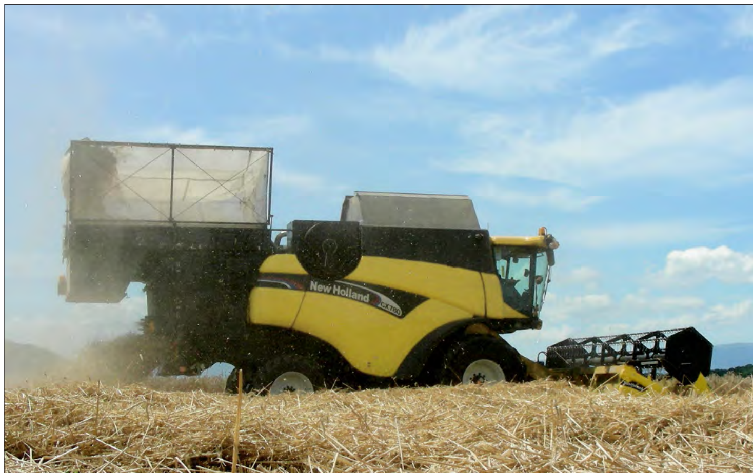
Der Spreusammler-Prototyp des SHL-Projektteams war letzten Sommer in Bellechasse FR im Einsatz. (Bild: shl)
