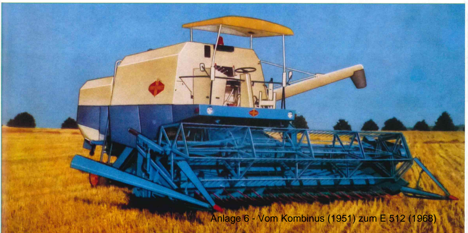
Abb. 143: Der Fortschritt E512 hatte einen Dieselmotor aus dem Motorenwerk Nordhaus mit 105 PS. Die Schnittbreite betrug bis zu 5,7 Meter. (Fortschritt 1976/Archiv Kühnstetter)
