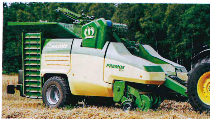
Hier der Premos 5000 im diesjährigen Einsatz. Die komplette Verarbeitung des Halmgutes von der Schwadaufnahme bis zum Abbunkern und Überladen der fertigen Pellets macht ihn zum ersten Pellet-Vollernter.
