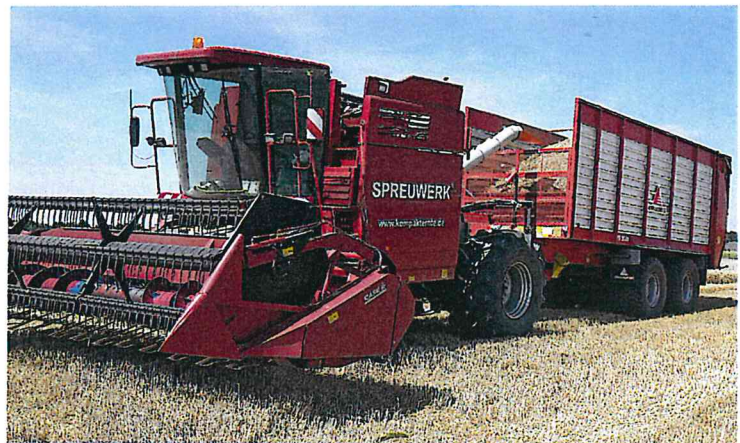
Bei der neuen Variante des Kompakternters kann der aufgesetzte Bunker durch einen angehängten Häckselwagen ersetzt werden. Foto: Rumpler/LLG
