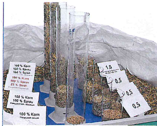
Das Gemisch aus Korn, Spreu und Kurzstroh verdichtet sich durch „Ineinanderschieben“ der Bestandteile von selbst. Dadurch sind gegenüber des Transportes des reinen Kornes meist nicht mehr Fahrten nötig.
