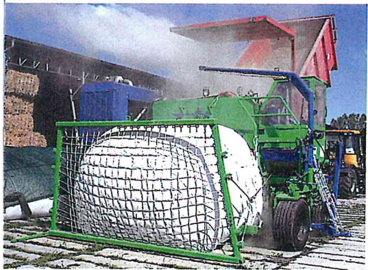
Beim Pressen von Spreu-Stroh zur Außenlagerung im Folienschlauch sind Dichten bis 200 Kilogramm je Kubikmeter erreichbar. Fotos: Carmen Rudolph
