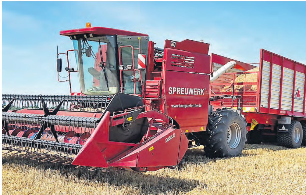
Ernte einer Mischfraktion aus Korn, Spreu und einem Teil des Strohs mit dem in der Landesanstalt für Landwirtschaft und Gartenbau Sachsen-Anhalt umgerüsteten Mähdrescher.
