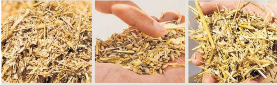
在测试装备的演示中，从压实收割机回收的混合物（左）中提取了仍需要进行后续清洁的谷粒（中），并分离了秸秆糠（右）。谷壳和杂草种子在抽出废气时进行收集。
