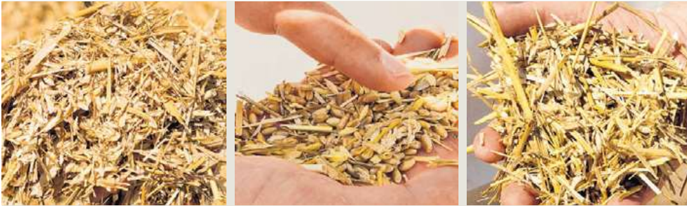
Aus dem vom Kompakterter geborgenen Gemisch (l.) wurden in einer Demonstration mit der Testanlage beim Feldtag Korn (M.), das noch einer Nachreinigung bedarf, und Strohhäcksel (r.) getrennt. Spreu und Unkrautsamen sammeln sich in der Luftabsaugung.
